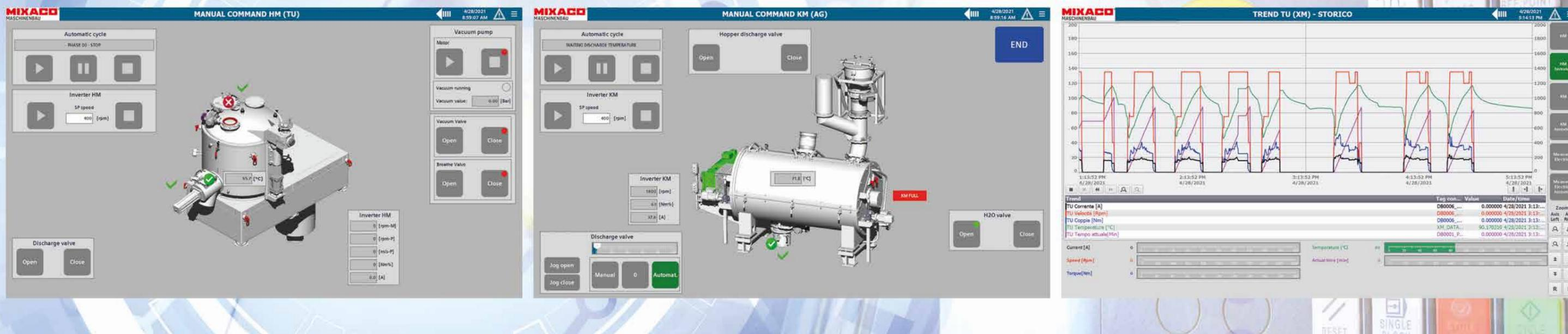
Nuestros mezcladores combinados caliente-frío se controlan mediante un PLC Siemens S7-1500 y cumplen con los requisitos actuales de seguridad, eficiencia y rentabilidad. Dado que el control ha sido desarrollado y programado por una misma compañía, está virtualmente garantizado que los componentes del mezclador están integrados de manera óptima. Alternativamente, también se pueden utilizar componentes de Allen Bradley (incluido el panel de
