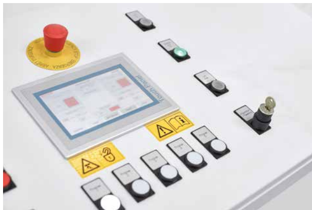
Bedienpult mit Hauptschalter, Not-Aus-Schalter und Programmwahltasten.
